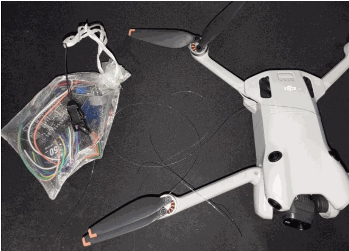
Carga útil ligada ao drone DJI Mini 4 Pro com 1.5m de fio de nylon
