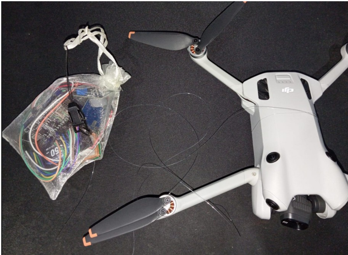
Carga útil ligada ao drone DJI Mini 4 Pro com 1.5m de fio de nylon
