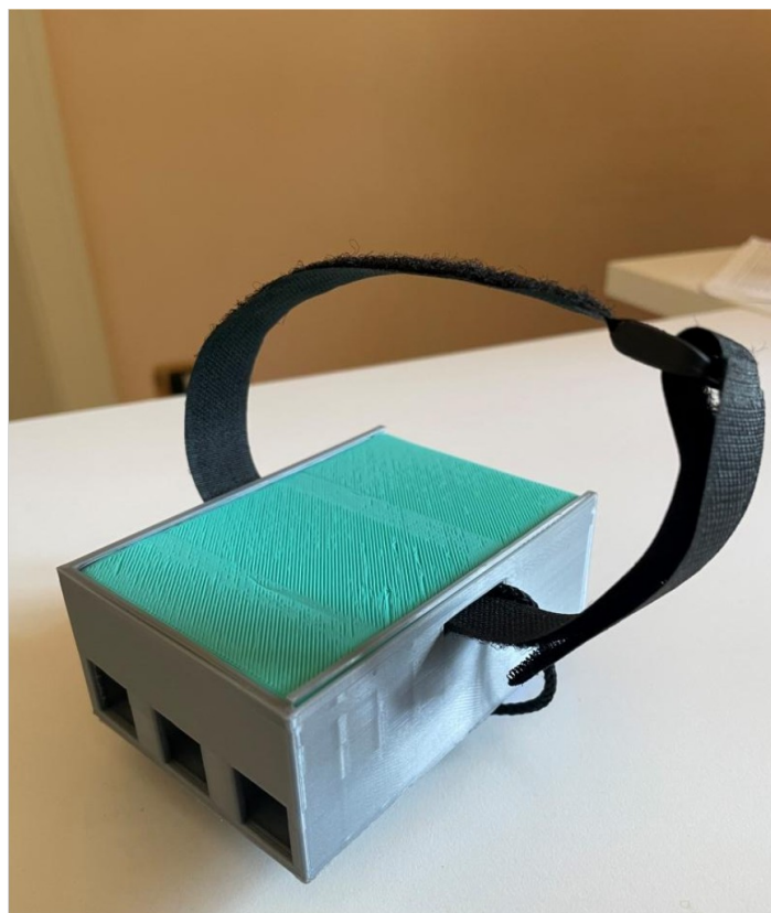
Integrácia senzora GUV-S12SD a zostavenie užitočného zaťaženia dronu (nižšie)
