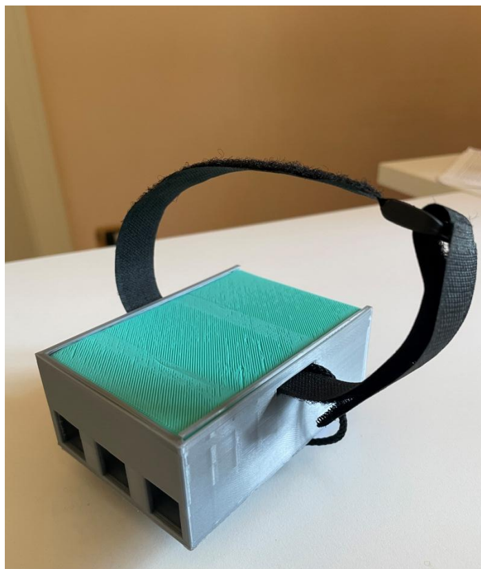
Integrazione del sensore GUV A-S12SD e assemblaggio del payload del drone(sotto)
