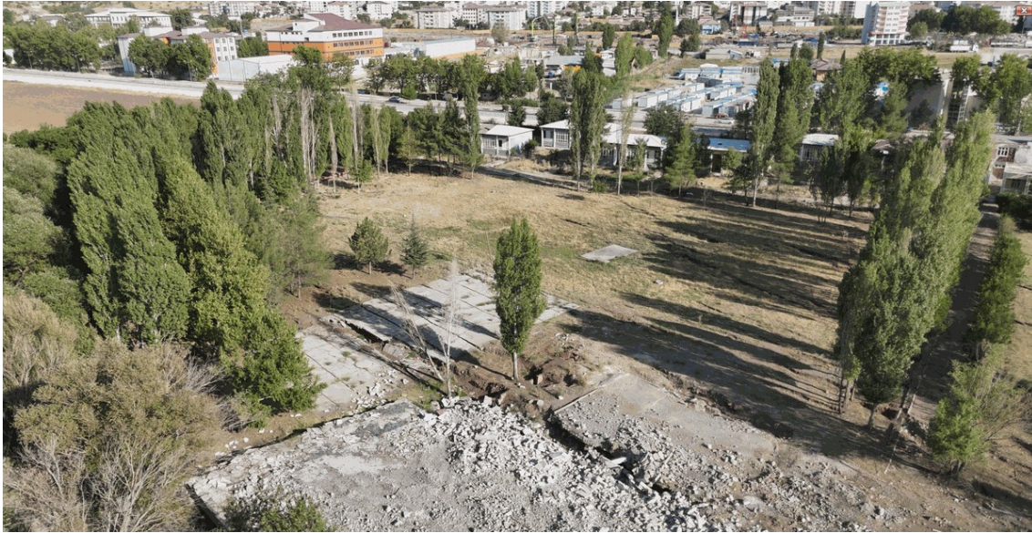
Figura 10. Imagem geral obtida por drone que mostra terreno deslocado atrás da zona de rotura junto ao lago, indicando a direção do espalhamento lateral e a acumulação de detritos remanescentes após um terramoto.
