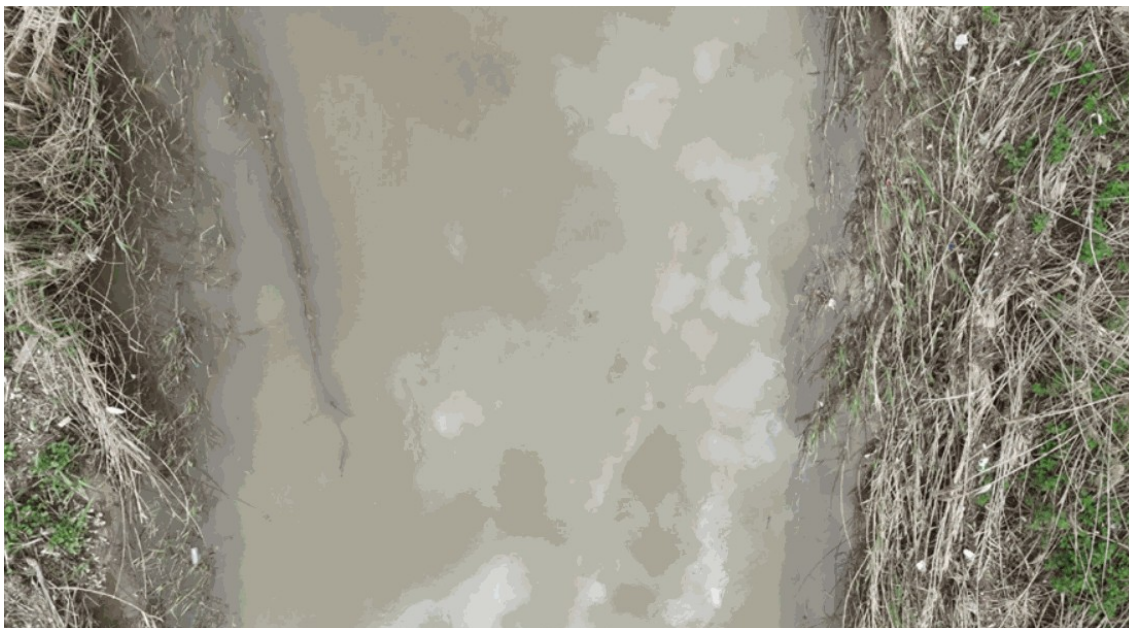
Figura 3. Vista superior, obtida por drone, de um troço de um ribeiro que apresenta uma elevada turbidez da água, caracterizada por uma coloração lamacenta e uma visibilidade reduzida. A imagem destaca os sedimentos em suspensão e as variações na transparência da água, apoiando a análise e a comparação dos níveis de turbidez durante a inspeção visual.
