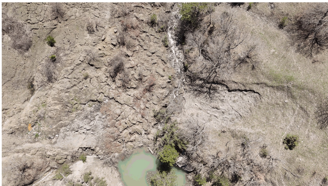
Figura 4. Vista aérea da área do sopé do deslizamento de terras, mostrando a interação ativa com o curso de água, onde os processos de erosão e socavamento no sopé são claramente visíveis. É possível observar a escavação da base do talude e o transporte de sedimentos, o que indica uma instabilidade contínua e a remoção progressiva de material na base do deslizamento de terras.
