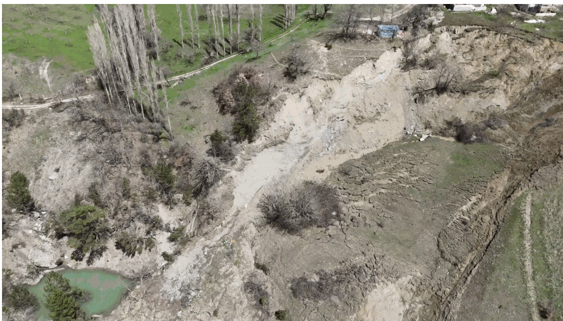
Figura 7. Vista aérea de um deslizamento de terras, mostrando a escarpa principal, massas de solo deslocadas e o movimento descendente de materiais ao longo do talude. São visíveis fissuras superficiais e padrões de deformação em todo o talude, enquanto a proximidade de terrenos agrícolas e de estruturas próximas evidencia potenciais zonas de risco. A interação limitada com o curso de água no sopé sugere uma influência reduzida da erosão, em comparação com os processos dominantes de rotura gravitacional do talude.
