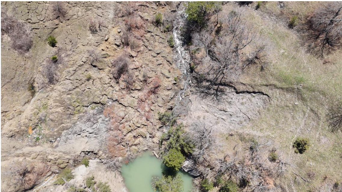
Figura 3. Vista aerea con drone di una frana che mostra zone contrastanti di stabilità ed erosione attiva. L'immagine evidenzia canali di erosione, crepe superficiali e aree di accumulo dell'acqua, consentendo il confronto tra parti del pendio relativamente stabili e in erosione attiva.
