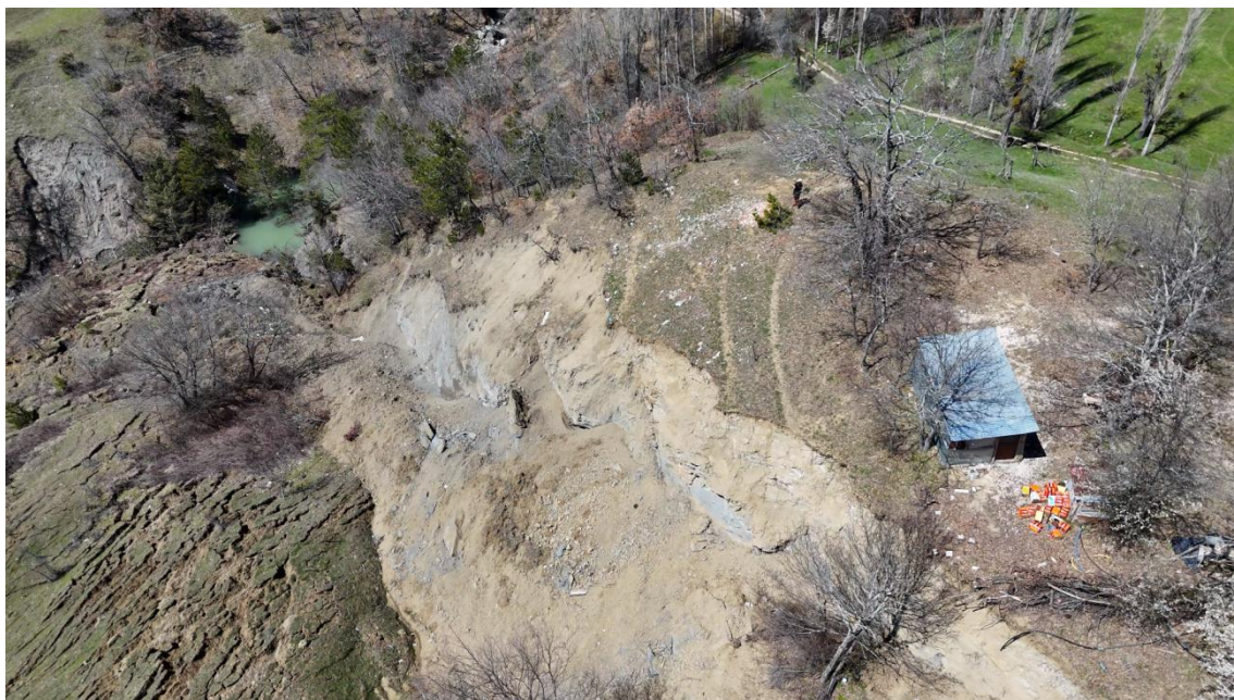
Figura 6. Vista aerea con drone di una frana attiva che colpisce un'area rurale, che mostra masse di terreno spostate, erosione alla punta del pendio e una struttura vicina a rischio. L'immagine evidenzia come il movimento dei pendii e l'erosione legata all'acqua possano minacciare le infrastrutture e richiedere un attento monitoraggio e mitigazione.
