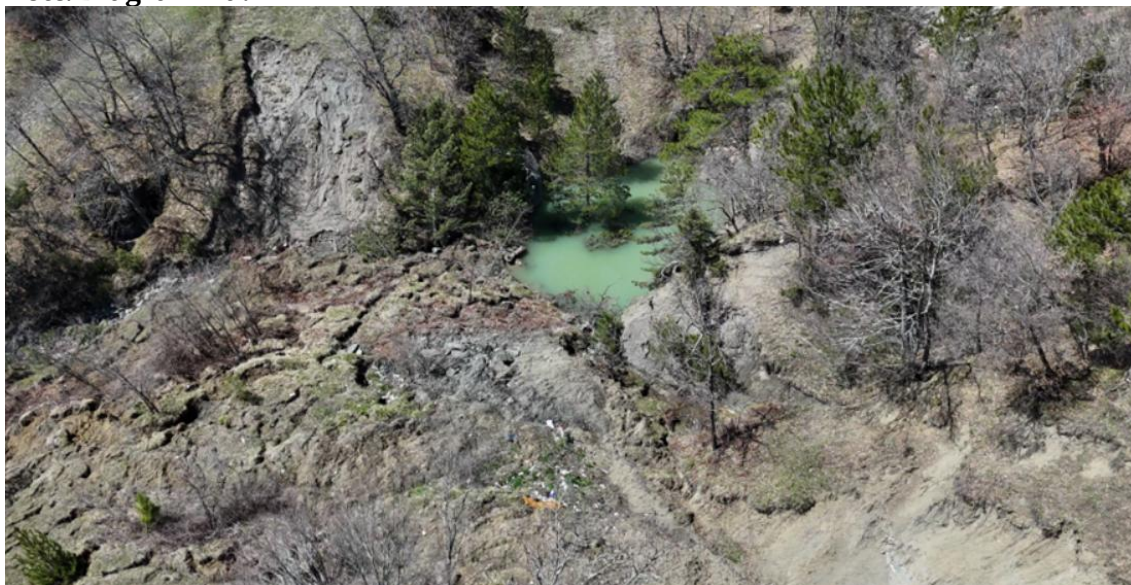
Figura 2. Vista aerea con drone di un'area del piede di una frana che mostra accumulo di acqua, canali di erosione ed effetti di erosione causati dal deflusso superficiale. L'immagine evidenzia come i processi guidati dall'acqua rimuovono il materiale alla base del pendio, riducendo potenzialmente la stabilità del pendio.
