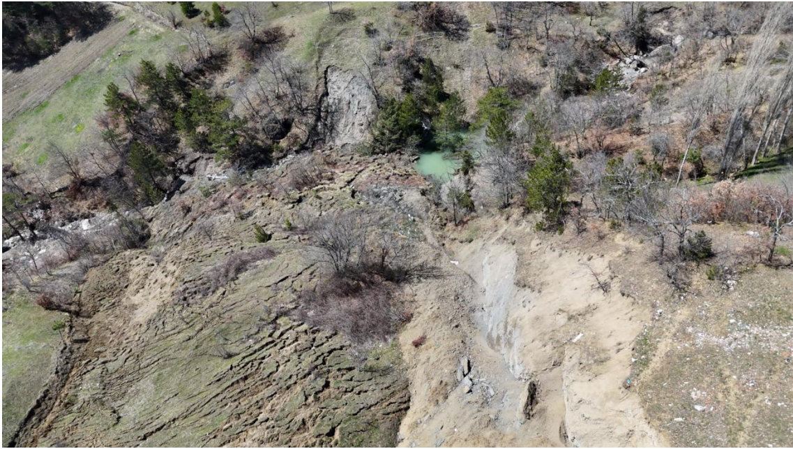
Figura 3. Vista aerea con drone di una frana che mostra zone contrastanti di stabilità ed erosione attiva. L'immagine evidenzia canali di erosione, crepe superficiali e aree di accumulo dell'acqua, consentendo il confronto tra parti del pendio relativamente stabili e in erosione attiva.
