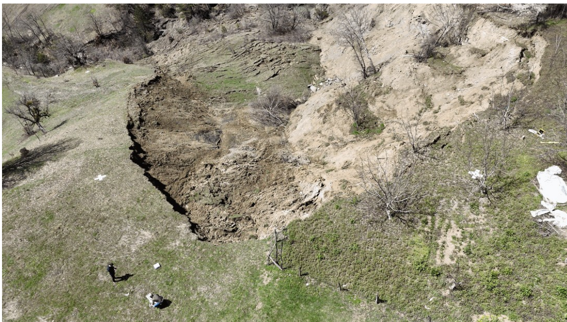
Figura 11. Vista geral, obtida por drone, de uma área de deslizamento de terras, mostrando a escarpa principal, a massa de solo deslocada e o terreno circundante, contribuindo para a avaliação em grande escala e a definição de prioridades durante a inspeção visual.
