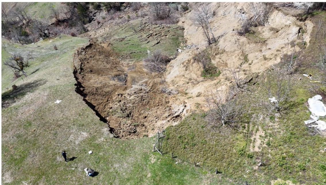
Figura 11. Panoramica basata su drone di un'area franata che mostra la scarpata principale, la massa di suolo spostata e il terreno circostante, supportando la valutazione su larga scala e la definizione delle priorità durante l'ispezione visiva.
