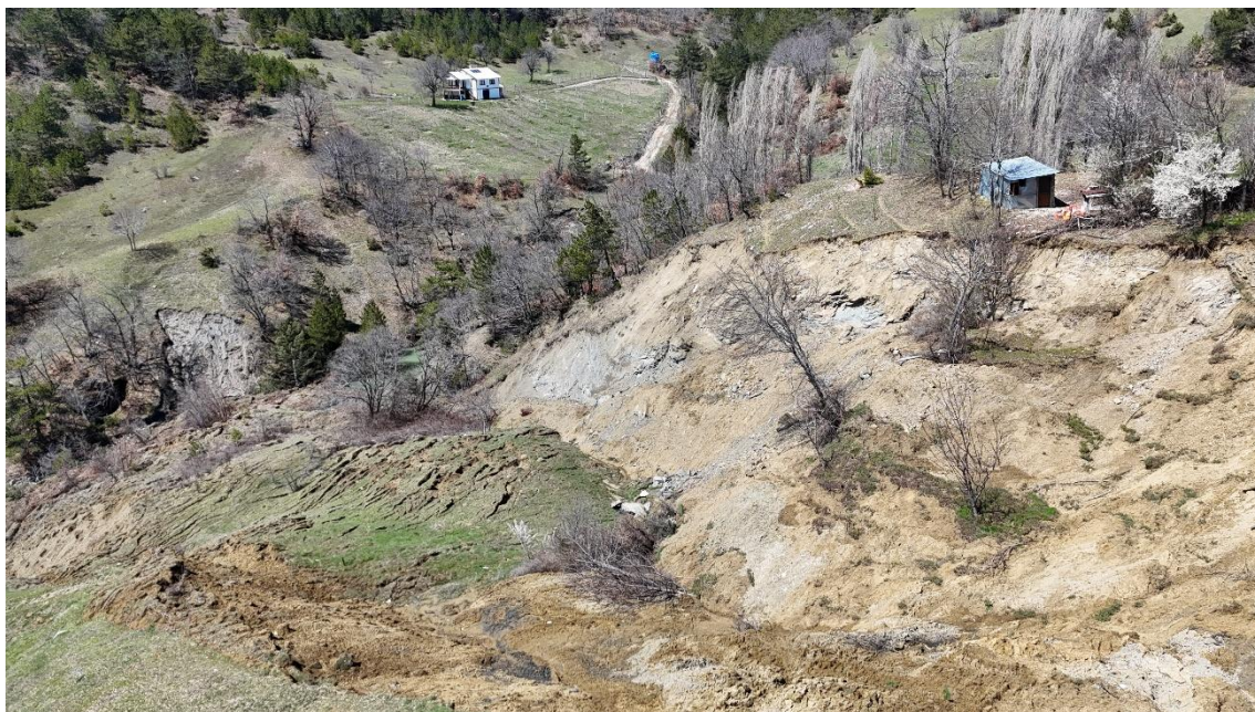
Figura 4. Ampia vista aerea di una frana che mostra la scarpata principale, la superficie di scorrimento rotazionale e l'area della punta, illustrando la geometria complessiva del cedimento del pendio e le caratteristiche principali utilizzate per l'analisi visiva.
