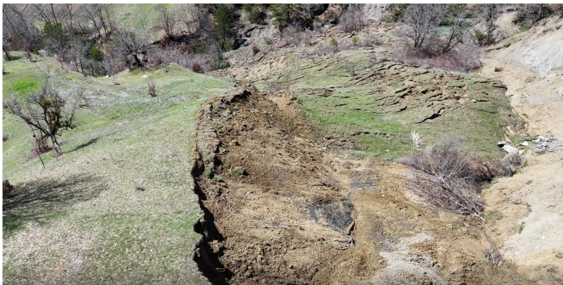
Figura 8. Vista ravvicinata con drone della scarpata della testa di una frana e della massa di terreno spostata, che distingue chiaramente tra terreno stabile e zone fallite e illustra le caratteristiche principali dell'instabilità del pendio.
