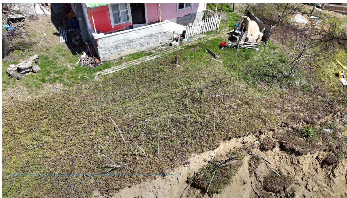
Figura 14. Vista ravvicinata effettuata da un drone che mostra la deformazione della superficie e un piccolo cedimento del pendio in prossimità di una struttura residenziale, evidenziando l'instabilità in fase iniziale e il potenziale rischio per gli edifici vicini.
