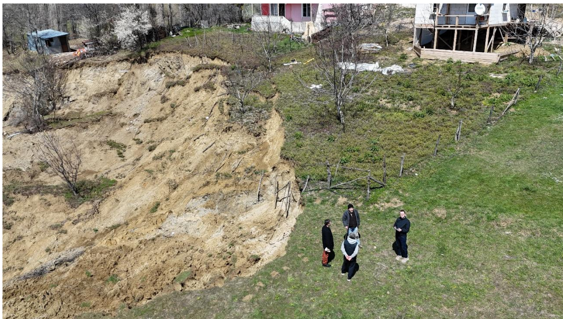
Figura 6. Vista basata su drone che mostra una scarpata di frana e un progressivo spostamento del suolo vicino a una struttura residenziale, evidenziando l'instabilità del terreno e il potenziale rischio per le infrastrutture vicine.
