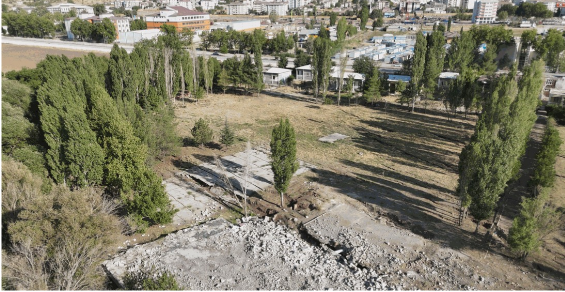
Şekil 10. Göl kenarındaki çöküntü bölgesinin gerisinde yer değiştirmiş zeminini gösteren genel bir dron görüntüsü; bu görüntü, deprem sonrası yanal yayılmanın yönünü ve geriye kalan enkaz birikimini göstermektedir.
