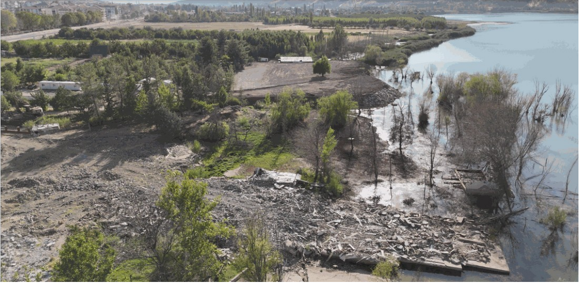
Şekil 1. Deprem sonrasında göl kıyısı boyunca toprağın yanal olarak dağılmasını gösteren genel bakış dron görüntüsü.
