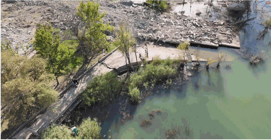
Şekil 5. Deprem sonrasında göl kıyısı boyunca döşeli bir alanda toprak kaymasının başladığını ve bu alanın kısmen su altında kaldığını gösteren dron görüntüsü.
