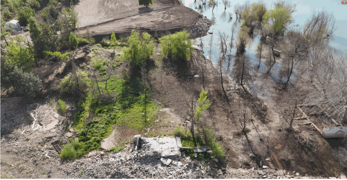
Şekil 8. Deprem sonrasında oluşan, toprak ve bitki örtüsünün karışık bir şekilde yer değiştirdiği bölgeyi gösteren eğik drone görüntüsü.
