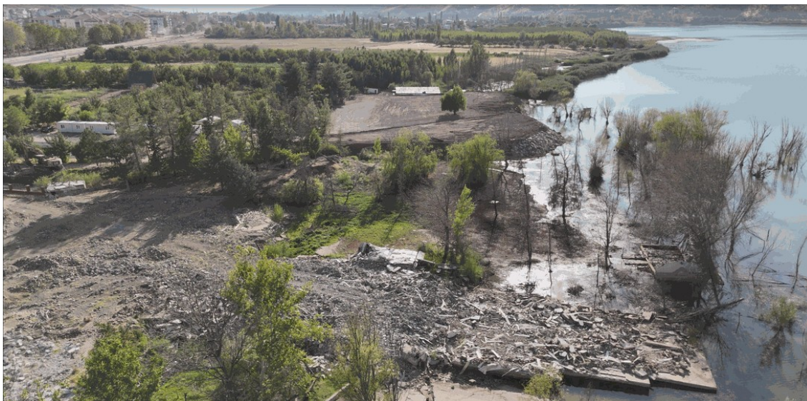
Obrázok 1. Celkový záber z dronu zobrazujúci bočné rozšírenie a posun pôdy pozdĺž brehu jazera po zemetrasení.
