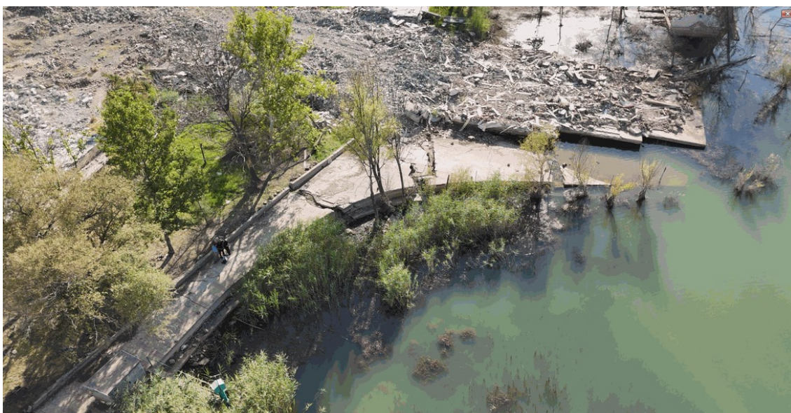
Obrázok 5. Záber z dronu zobrazujúci začínajúci bočný posun pôdy a čiastočné zaplavenie spevnenej plochy pozdĺž brehu jazera po zemetrasení.
