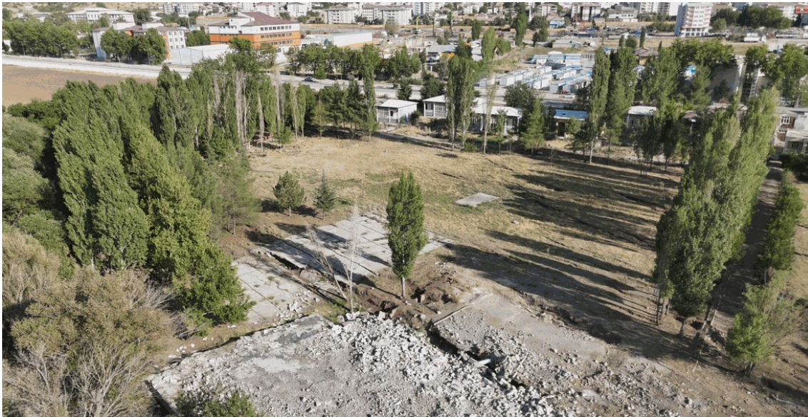
Obrázok 10. Celkový záber z dronu zobrazujúci posunutý terén za zónou porušenia brehu jazera, naznačujúci smer bočného rozširovania pôdy a nahromadené zvyšky po zemetrasení.
