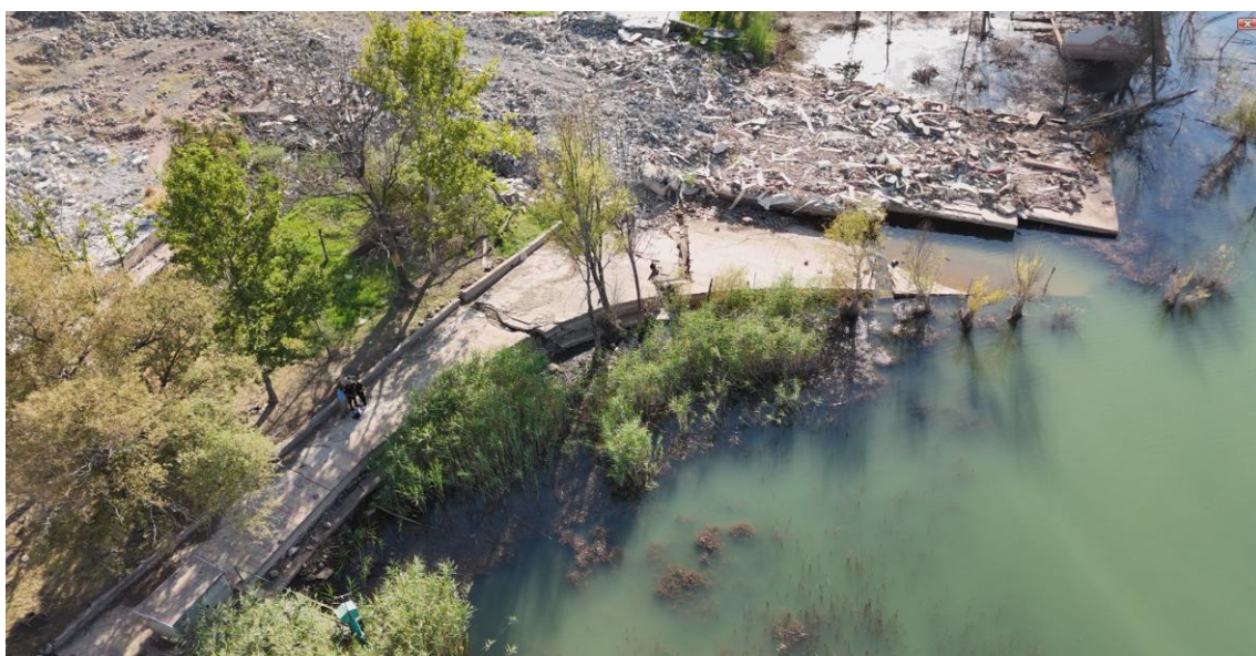
Figura 5. Riprese aeree effettuate con un drone che mostrano l'inizio dello spostamento del terreno e il parziale allagamento di un'area pavimentata lungo la riva del lago in seguito a un terremoto.
