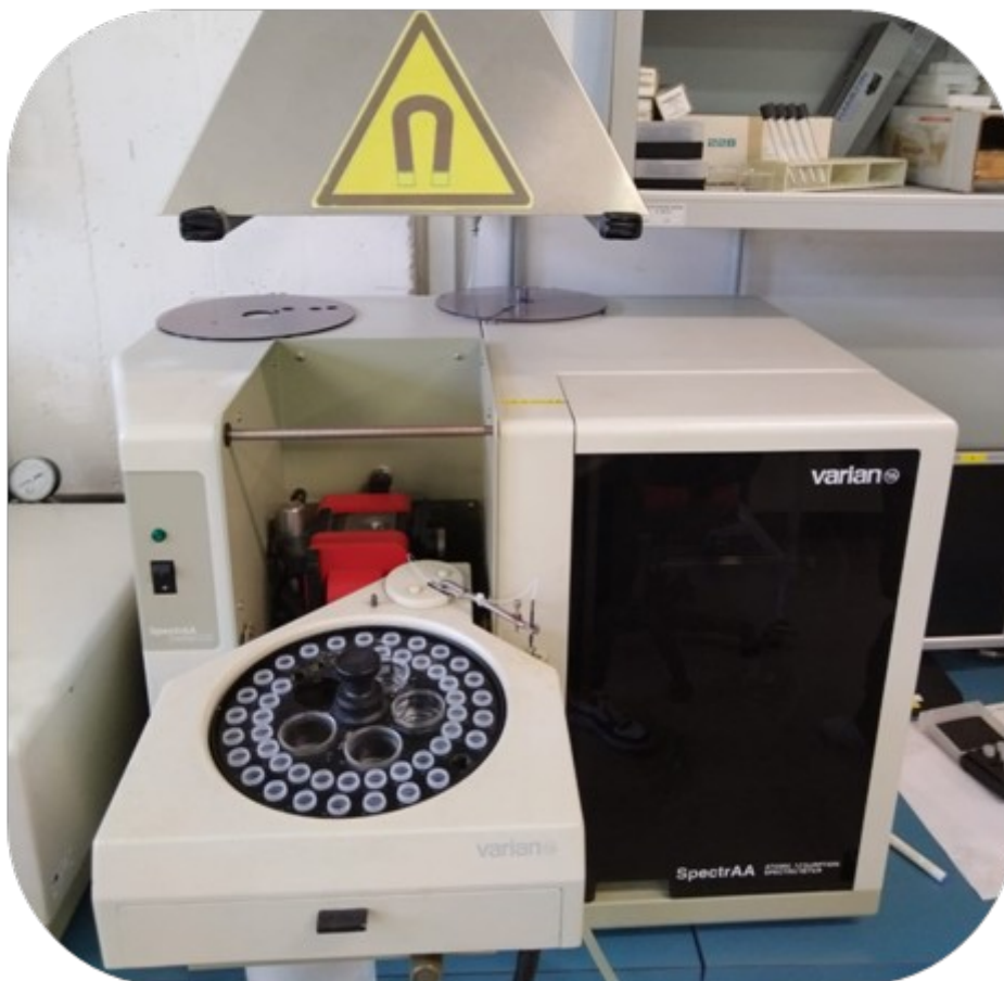
Vysokopresný prístroj umožňujúci merať množstvo ťažkých kovov v roztoku s citlivosťou na úrovni stotín ppb (ng/l).
