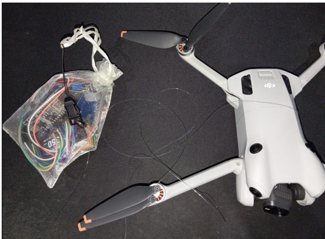
Zaťaženie pripojené k dronu DJI Mini 4 Pro pomocou 1.5 m dlhého nylonového lanka
